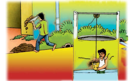
சேமிப்புக் கிணற்றில் உள்ள கசடுகளை அகற்றவும். Remove the silt in the recharge well.
